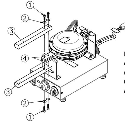
Fixe os cabos de madeira (3) em ambas as chapas antiaderentes (4) utilizando as arruelas (2) e os parafusos (1); Certifique-se que os parafusos (1) estejam bem apertados.
