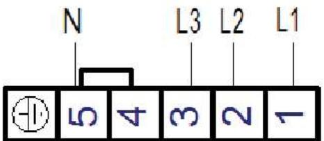
**⚠ Antes de instalar o equipamento, verifique na régua de borne de ligação, se a tensão configurada é a mesma da rede elétrica de instalação.**
